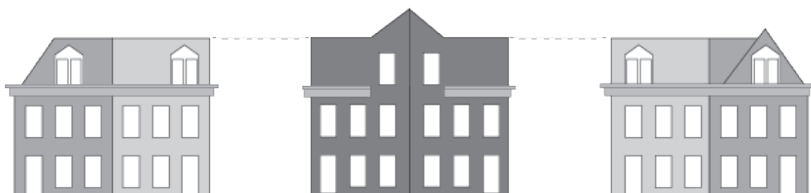
Compositie met verbijzonderde beëindigingen en centraal accent Deze opzet is verplicht bij 6 of meer woningen
